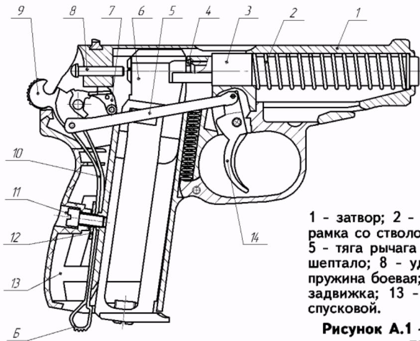
1 - затвор; 2 - пружина возвратная; 3 - рамка со стволов; 4 - прокладка ствола; 5 - тяга рычага взвода; 6 - магазин; 7 - шептало; 8 - ударник; 9 - курок; 10 - пружина боевая; 11 - винт рукоятки; 12 - задвижка; 13 - рукоятка; 14 - крючок спусковой.
