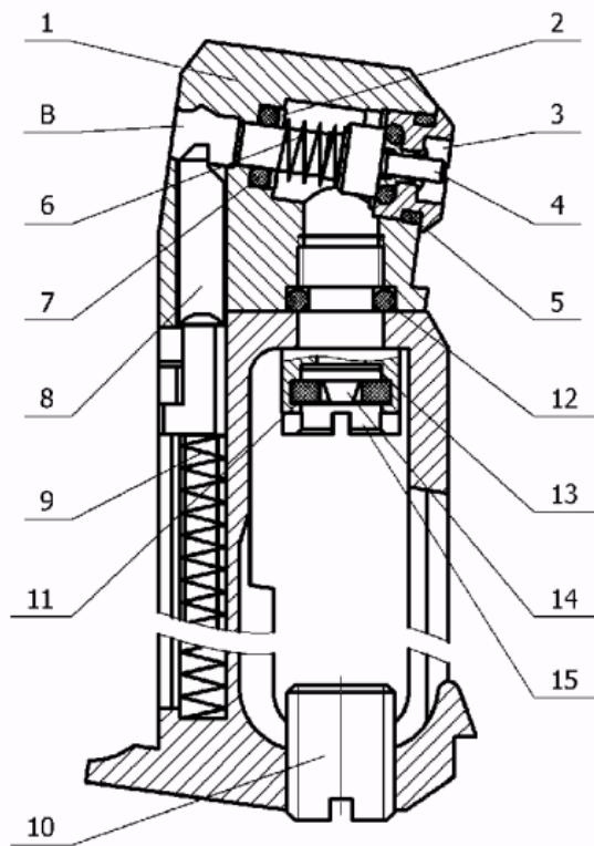
1 - корпус клапана; 2 - шайба; 3 - седло клапана; 4 - клапан; 5 - кольцо; 6 - пружина клапана; 7 - кольцо клапана; 8 - подаватель; 9 - пружина подавателя; 10 - винт поджимной; 11 - элемент запорный; 12 - кольцо уплотнительное; 13 - фильтр; 14 - игла; 15 - обтюратор.
