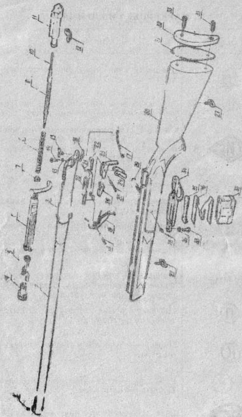
Рис. 4. Ружье промысловое одноствольное магазинное МЦ 20-01. Сборочные единицы и детали.
